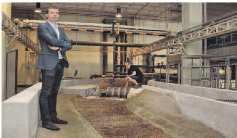
**La UCI de Rande o la Pedra de Abalar.** En los laboratorios del Citeec, Juan Rabuñal (izq.) y Félix Sánchez-Tembleque testan materiales como el hormigón con una megaprensa de rotura o realizan ensayos aerolásticos, como uno sobre el puente de Rande. Uno de sus encargos fue reparar la Pedra de Abalar de Muxía. En la imagen vemos la recreación de la central de Ocaña, de Ecuador. FOTOS DE PEDRO MACEIRA
