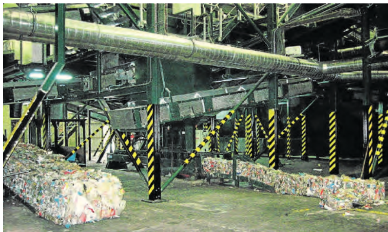
Proceso de prensado y empaquetado de envases en el complejo medioambiental de Sogama | AEC
